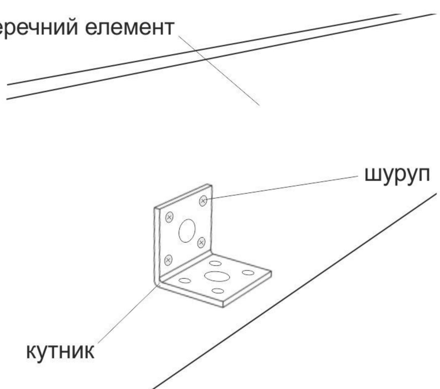
Знайдіть на поперечних елементах попередньо підготовані отвори і використовуючи хрестоподібну викрутку та шурупи, прикріпіть до неї металевий кутник, як показано на малюнку.
