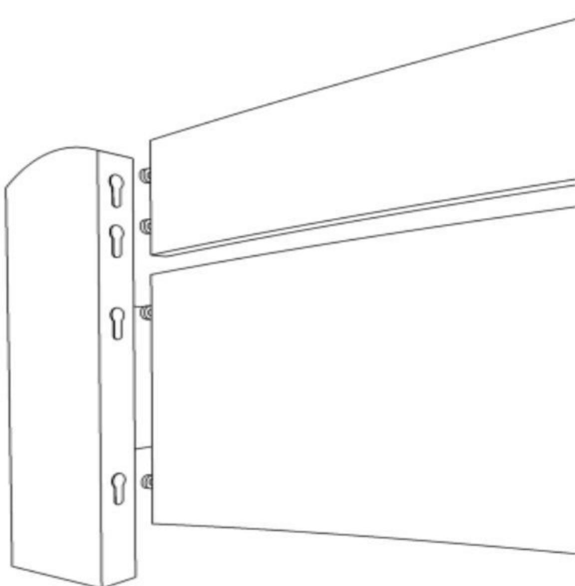
Для складання деталей використовується клиноподібне з'єднання. Потрібно вставити одну деталь в іншу, та з силою натиснути на торець вниз до упору і деталі зібрані. Якщо Вам здається, що деталі стяглися між собою недостатньо щільно, потрібно підтягнути гвинти хрестоподібної викруткою на потрібну відстань, та повторити спробу.
