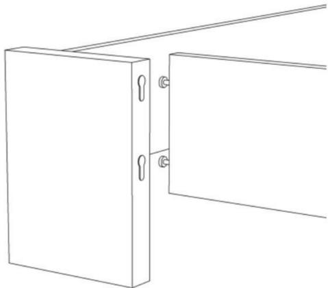
Для складання деталей використовується клиноподібне з'єднання. Потрібно вставити одну деталь в іншу, та з силою натиснути на торець вниз до упору і деталі зібрані. Якщо Вам здається, що деталі стяглися між собою недостатньо щільно, потрібно підтягнути гвинти хрестоподібної викруткою на потрібну відстань, та повторити спробу.
