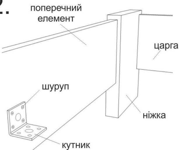
Знайдіть на поперечних елементах попередньо підготовані отвори і використовуючи хрестоподібну викрутку та шурупи, прикріпіть до неї металевий кутник, як показано на малюнку.
