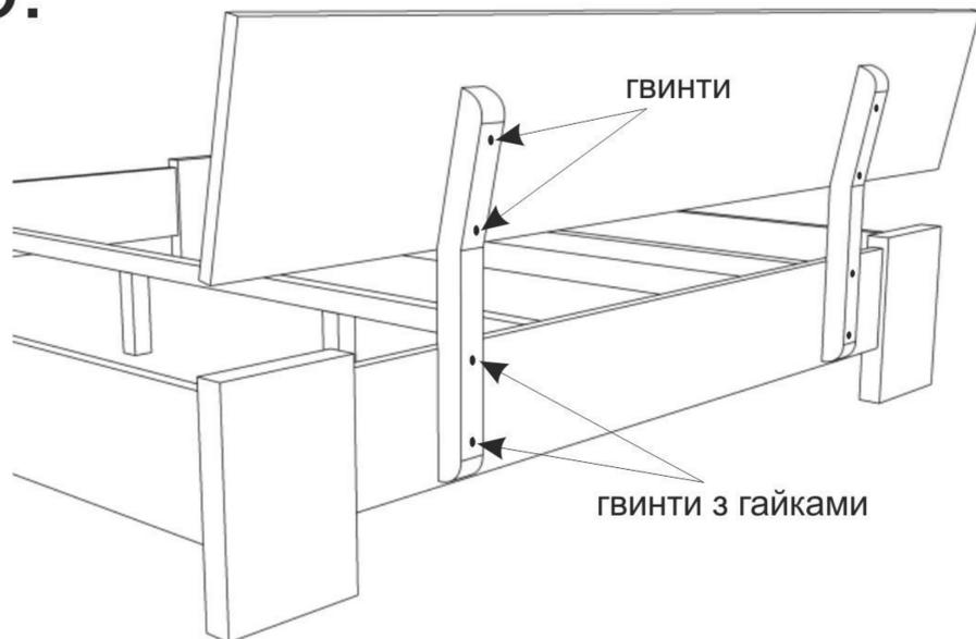
Для кріплення спинки до поперечного елемента використовуються стійки які кріпляться до нього гвинтами з гайками та гвинтами до спинки.
