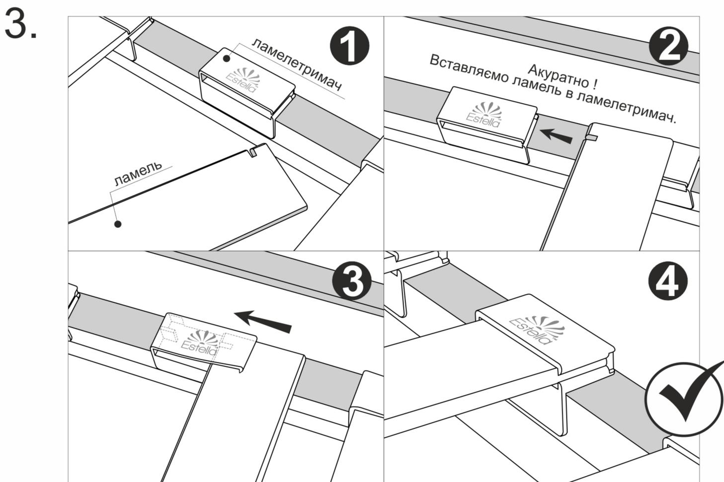
На зображенні зліва Ви бачите процес фіксації ламелей у ламелетримачах. Матеріал з якого вони зроблені має час від часу доволі різну пластичність на яку ще й до того впливає навколишня температура. Якщо не йде, допоможіть ламелі залізти, трішки припіднявши вільною рукою верхній край ламелетримача.
