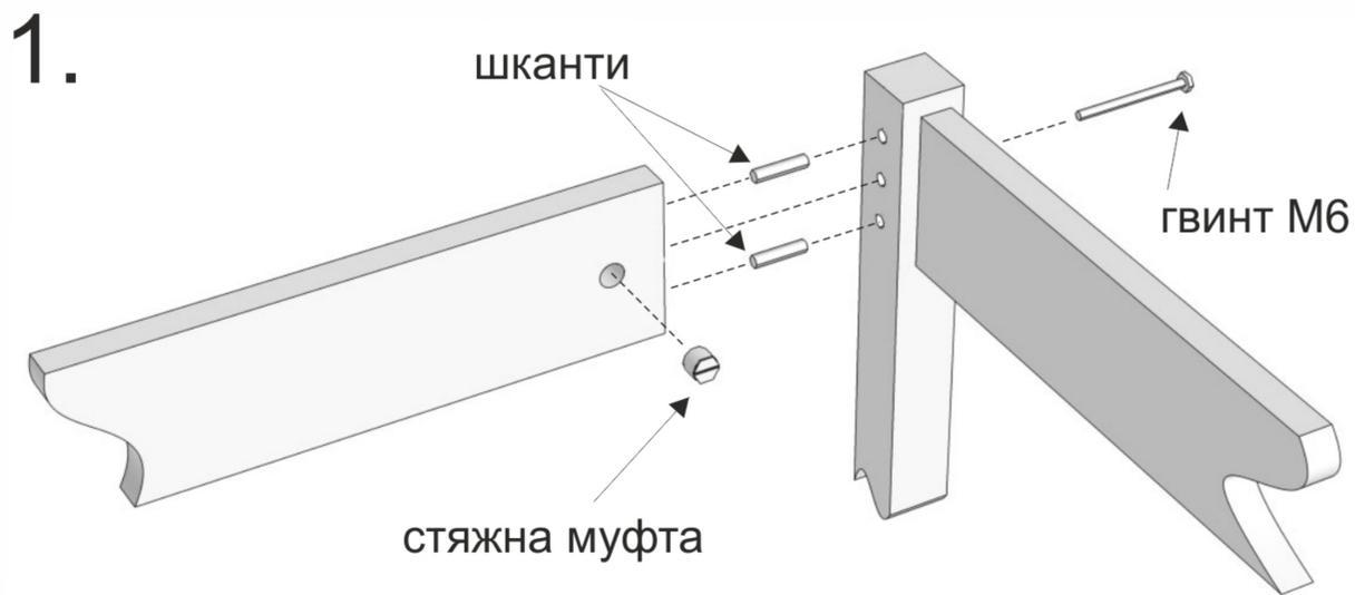
Для складання елементів використовуються стяжні та шкантові з'єднання. Шканти потрібно вставити в отвори як показано на зображенні вище. Потім з'єднати елементи та вкрутити гвинт у встановлену стяжну муфту.
