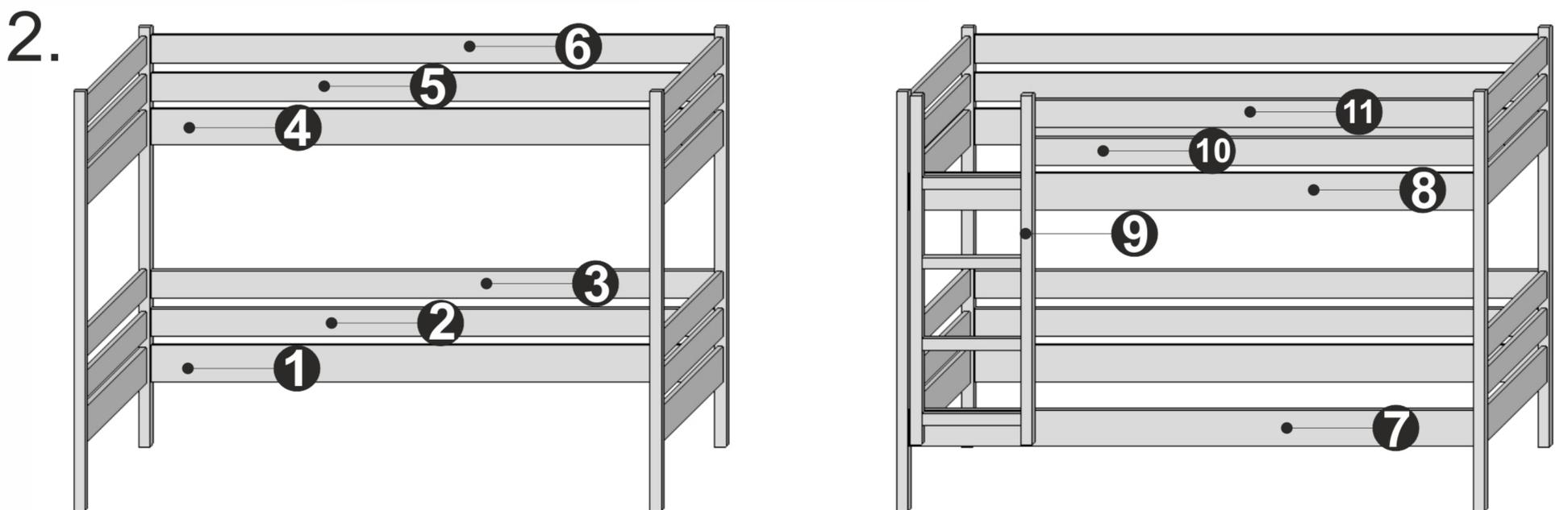
Тут потрібен помічник, без нього ризикуєте щось пошкодити! Починайте з нижньої царги злегка з'єднавши перші елементи продовжуйте монтаж по черзі як на зображенні вище. Після їх встановлення з силою затягніть усі гвинти та перевірте усі з'єднання.
